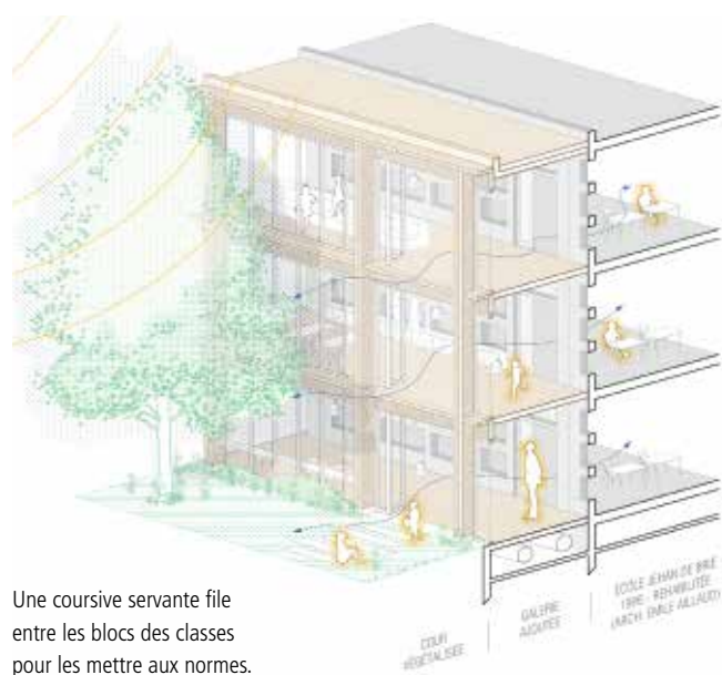
Des circulations verticales extérieures en bois et des loggias viennent équiper les logements existants désormais traversants.
