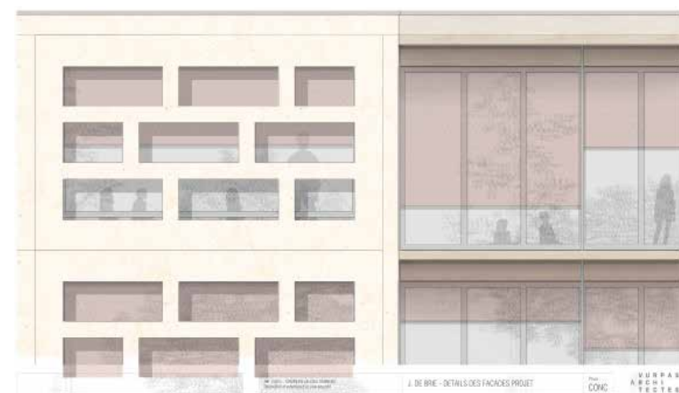
Détail de l'articulation de la façade de l'école en béton préfabriqué à la coursive de desserte en bois.
